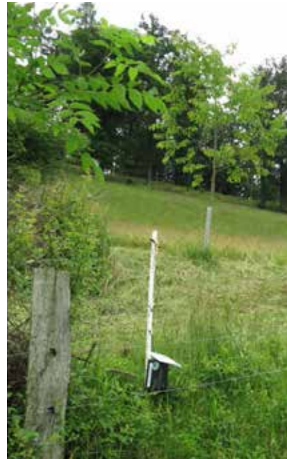
BatLogger, ein programmierbarer Ultraschalllogger zur Aufzeichnung von Fledermaus-Durchflügen. Installiert auf einer Wiese zwischen Lätt und Suhrerchopf. Foto: Martin Obrist
