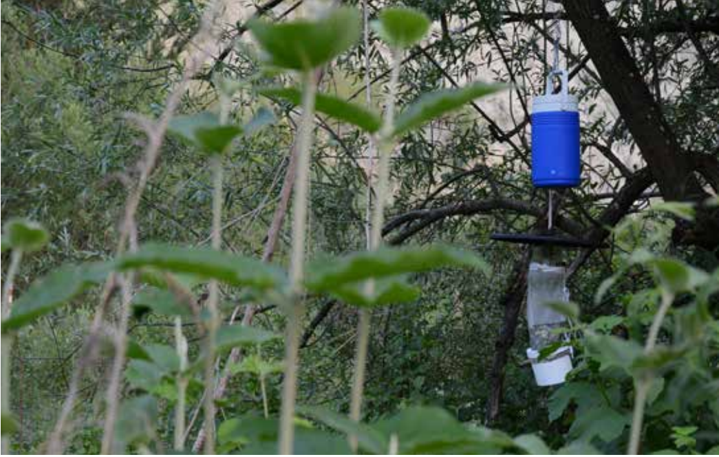
Das CO 2 im Behälter lockt Stechmücken in die Sammelfalle.
